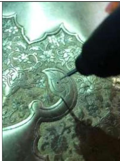
تصویر (۱۱)، آغاز مرحله سوراخ کاری و شروع برش کاری و مشبک کاری
